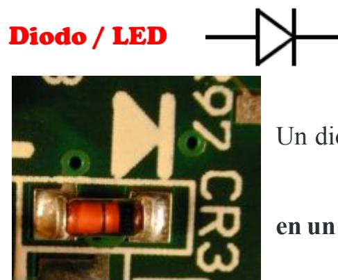
Un diodo es un dispositivo hecho de material semiconductor, que **restringe el flujo de corriente en un circuito en una sola dirección**, gracias a ello bloqueará la mayor parte de cualquier corriente
