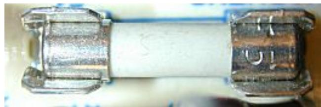
Un fusible es un **dispositivo diseñado para proteger a otros componentes del daño accidental debido a la corriente excesiva que fluye a través de ellos**. Cada
